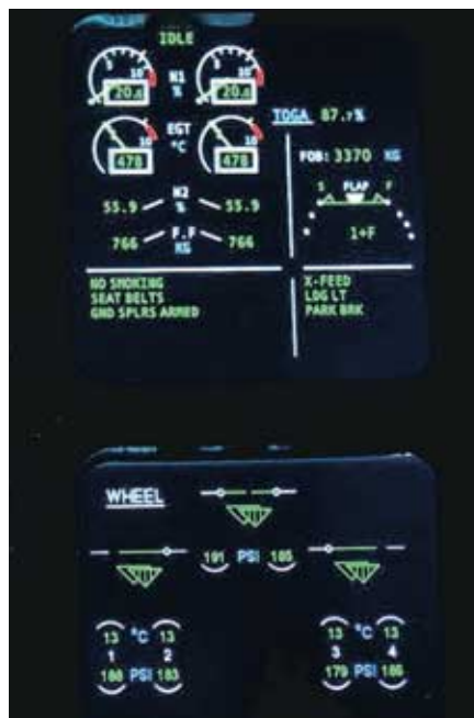
Diese Anzeige meldet die Triebwerksleistung (oben) und den Reifenzustand.
